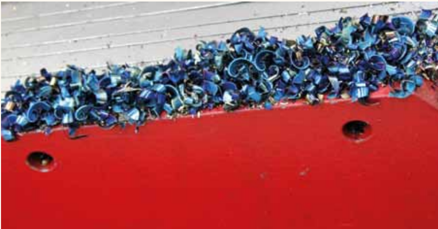
Bild 8: Tiefblau angelaufene Späne belegen die Härte des Einsatzes beim Schruppen (Werkbilder: 1, 2, 3, 6, 8: Klaus Vollrath)
