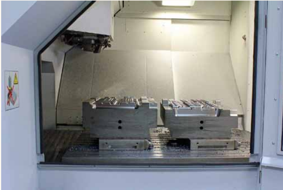
Bild 6: Auf den großen Tisch passen zwei der üblichen Werkstücke. Man braucht diese nur noch ungefähr passend auf den Magnetspannern aufzusetzen und kurz einzumessen, und schon kann die Anlage weiter spanen
