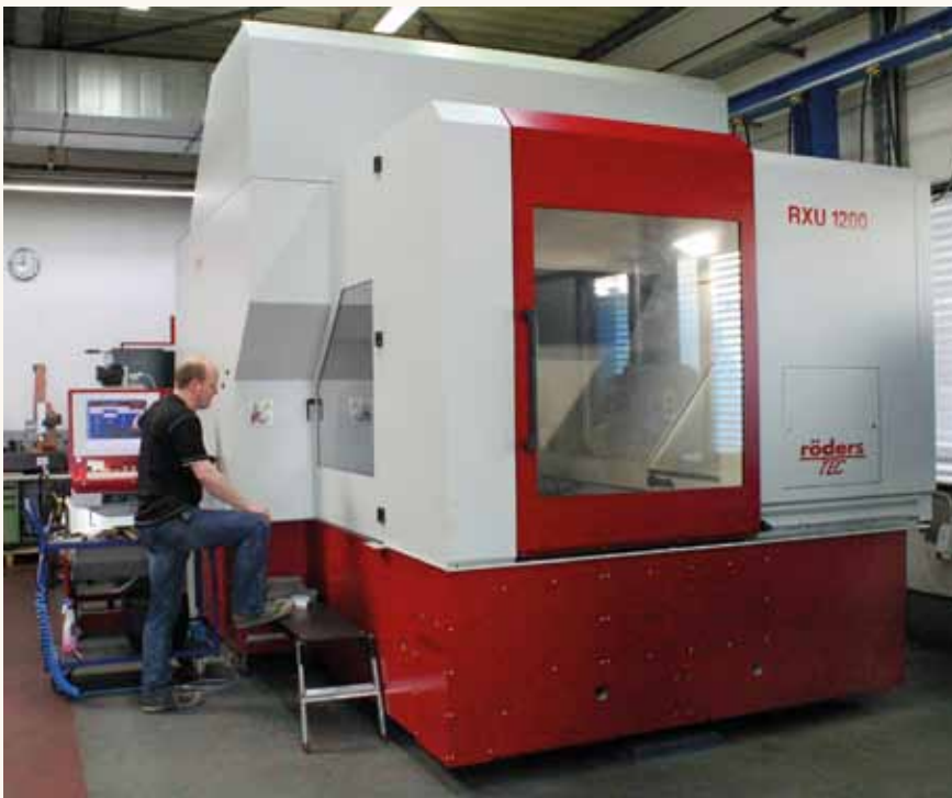
Bild 1: Mit dem neuen Bearbeitungszentrum Rödgers RXU 1200 benötigt Fa. Klein jetzt lediglich 19 statt wie bisher 31,5 Stunden für die Bearbeitung einer Gesenkhälfte
