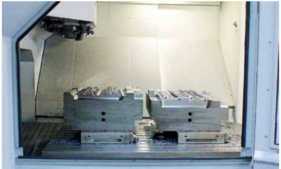
Auf den großen Tisch passen zwei der üblichen Werkstücke. Man braucht diese nur noch ungefähr passend auf den Magnetspannern aufzusetzen und kurz einzumessen, und schon kann die Anlage weiter spanen.
